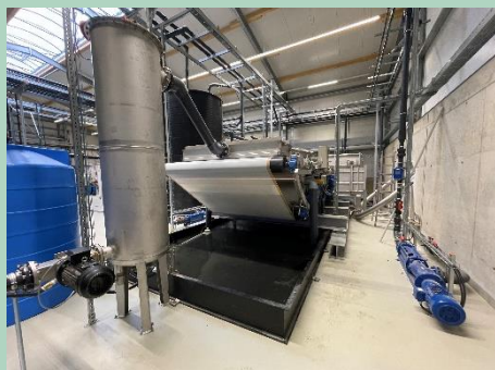
Siebbandpresse mit Pufferbehälter Für Gärrest (1. Prozessschritt)
