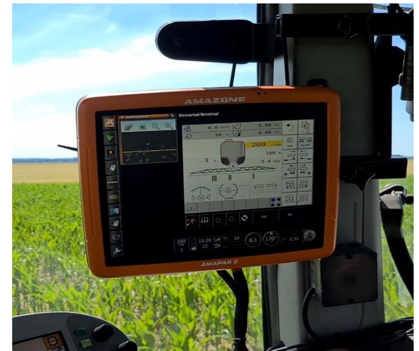
Terminal AMAPAD 2 Terminal während des Spotspraying,
