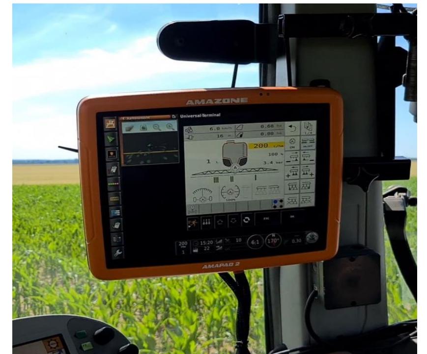
Terminal AMAPAD 2 Terminal während des Spotspraying,
