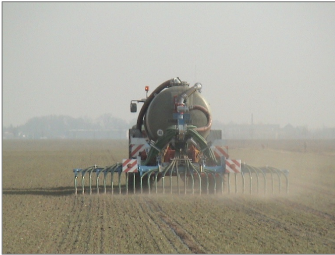
Abbildung 13: Einsatz moderner Technik bei der Gülleapplikation zur Minderung der Stickstoffemissionen und zur Verbesserung der N-Effizienz
