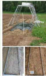
Bodenabtragmessungen mit Niederschlagsimulator
