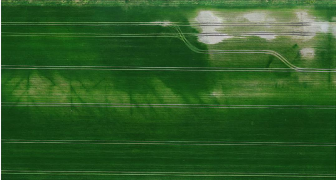
Abbildung: Schadensbilder defekte Dränage [Apus Systems]
