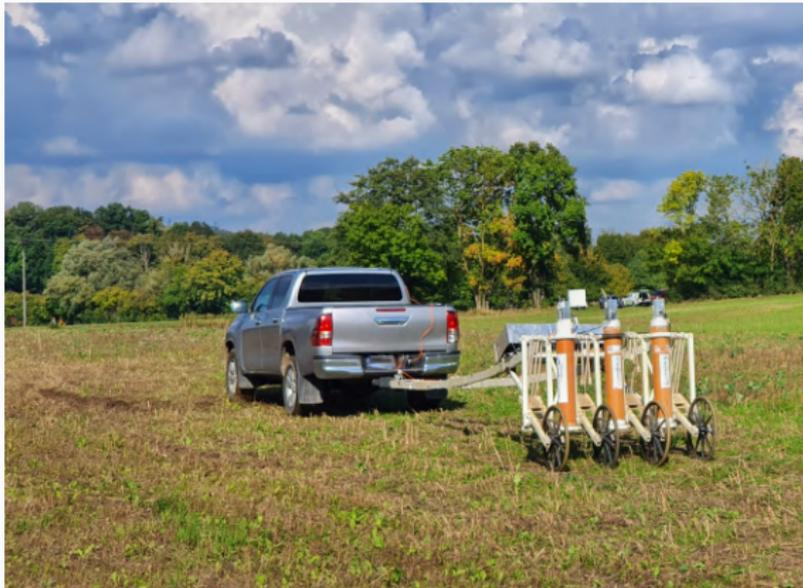
Abbildung: Projekt "ratiogeo", SQUID-Sensoren [Apus Systems]
