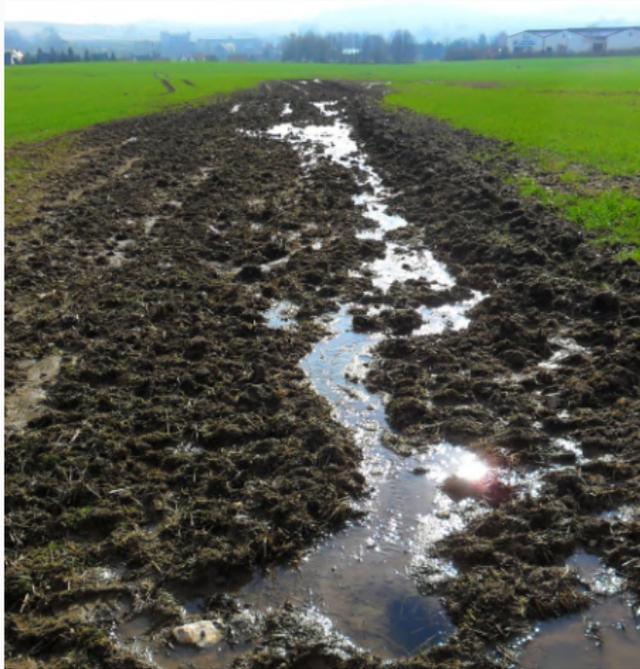
Abbildung: Schadensbilder defekte Dränage [Apus Systems]
