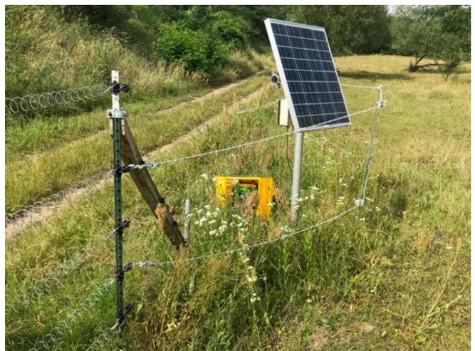
Stromversorgung mit Solargerät ist möglich
