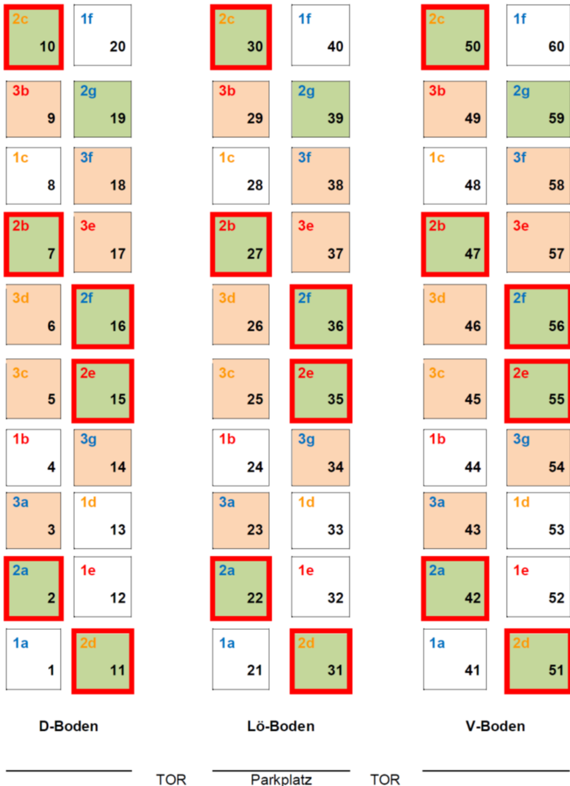
Abbildung 6:1: Lysimeteranlage Nossen, bestehend aus 60 einzelnen Lysimetern (Nummerierung 1-60). Jeweils 20 Lysimeter sind mit einem Boden sächsischer Herkunft befüllt (links D-Boden , Mitte Lö-Boden , rechts V-Boden ). Drei verschiedene Bodenbearbeitungsmethoden wurden eingesetzt (farbliche Füllung und Nummerierung 1-3: weiß bzw. 1 = ohne Bodenbearbeitung bzw. Direktsaat, grün bzw. 2 = Grubber, rosa bzw. 3 = Pflug bzw. Spaten). Drei verschiedene Düngervarianten wurden untersucht ( a, f und g = AS-HS, b und e = AS-HS+UI, c und d = AS-HS+UI+NI). Lachgasmessungen sowie Sickerwasserprobennahmen für die ökotoxikologischen und chemischen Analysen wurden auf den rot umrandeten Lysimetern durchgeführt. Für die Bodenproben für die ökotoxikologischen Analysen wurden von den rot umrandeten Lysimetern die mit den Düngervarianten AS-HS und AS-HS+UI+NI ausgewählt (Lysimeter 2, 10, 11, 16, 22, 30, 31, 26, 42, 50, 51, 56).
