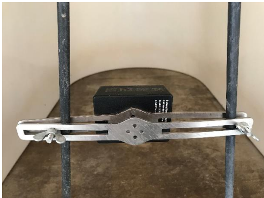
Abbildung 1: Mittels mitgeliefertem Montagematerial am Kälberauslauf angebrachter Infrarotsensor (Front- und Gegenplatte, Schrauben, Flügelmuttern)
