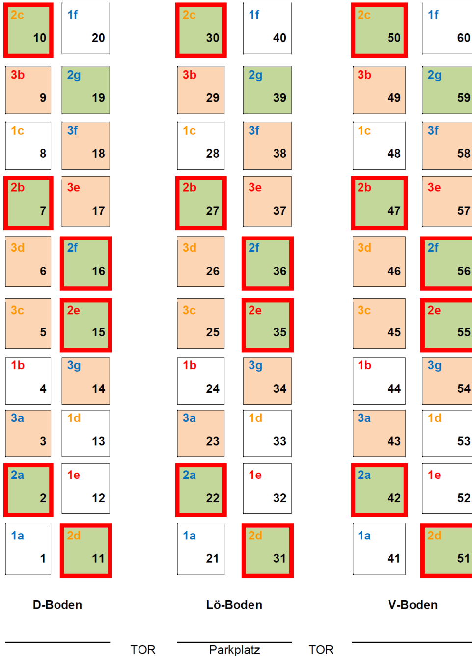
Abb. 5: Übersicht der Lysimeteranlage Nossen, bestehend aus 60 einzelnen Lysimetern (Nummerierung 1-60). Jeweils 20 Lysimeter sind mit einem Boden sächsischer Herkunft befüllt (links D-Boden , Mitte Lö-Boden , rechts V-Boden ). Drei verschiedene Bodenbearbeitungsmethoden werden seit 2013 eingesetzt (farbliche Füllung und Nummerierung 1-3: weiß bzw. 1 = ohne Bodenbearbeitung bzw. Direktsaat, grün bzw. 2 = Grubber, rosa bzw. 3 = Pflug bzw. Spaten). Drei verschiedene Düngervarianten wurden im Rahmen des Projekts untersucht ( a, f und g = AS-HS, b und e = AS-HS+UI, c und d = AS-HS+UI+NI). N 2 O-Messungen sowie Sickerwasserprobennahmen für die ökotoxikologischen und chemischen Analysen wurden auf den rot umrandeten Lysimetern durchgeführt. Für die Bodenproben für die ökotoxikologischen Analysen wurden von den rot umrandeten Lysimetern die mit den Düngervarianten AS-HS und AS-HS+UI+NI ausgewählt (Lysimeter 2, 10, 11, 16, 22, 30, 31, 26, 42, 50, 51, 56).
