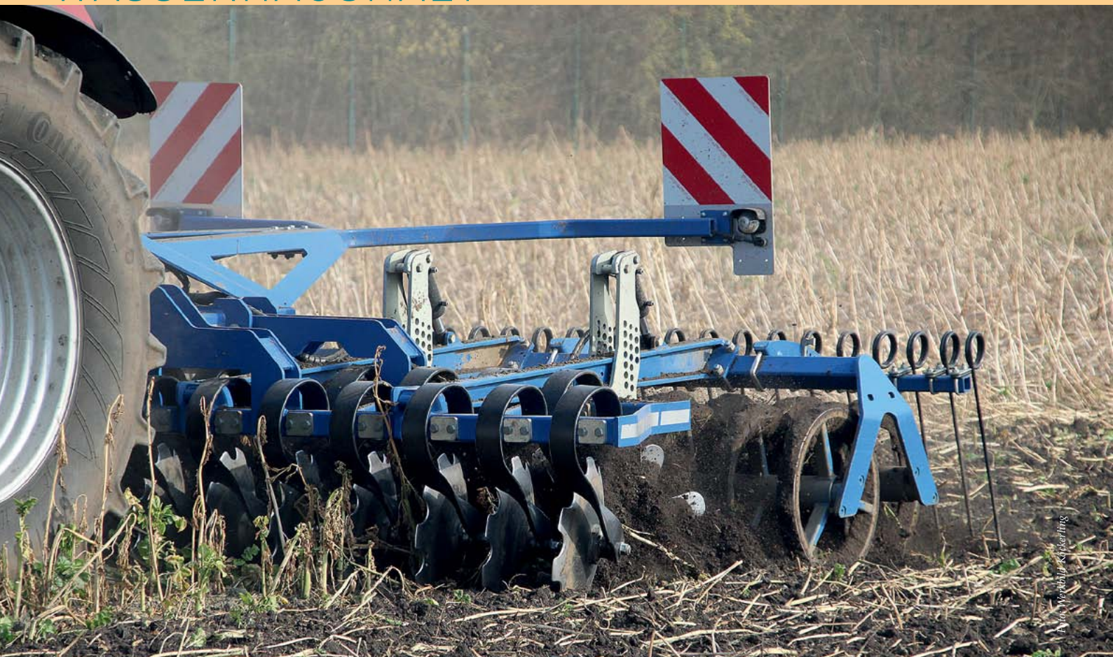
Saatbettbereitung bei Mulchsaaten: Der abgefrorene Zwischenfruchtmulch wird vor der Bestellung in den Boden eingearbeitet.
