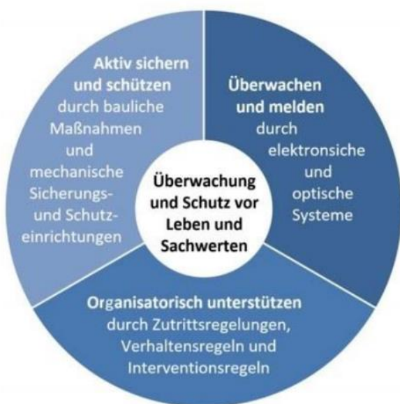
Abbildung 2: Säulen der Sicherungstechnik
