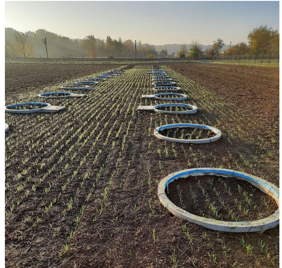
Abb. 6: Blick über das Lysimeterfeld mit Lysimetern im Vordergrund und Versickerungsmessern im Hintergrund
