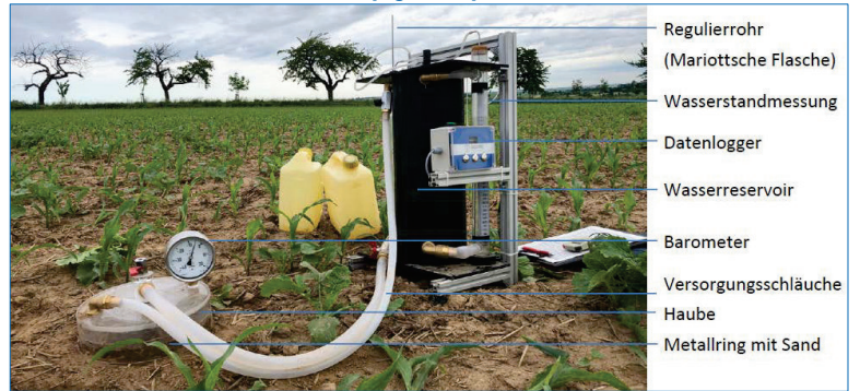
Messung Infiltrationsraten (3 unterschiedliche Saugspannungen, je 3 Messpunkten/Schlag)
