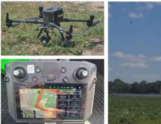
**Abbildung 3: Eingesetzte Drohne und Flugroute (Display der Fernbedienung)**
