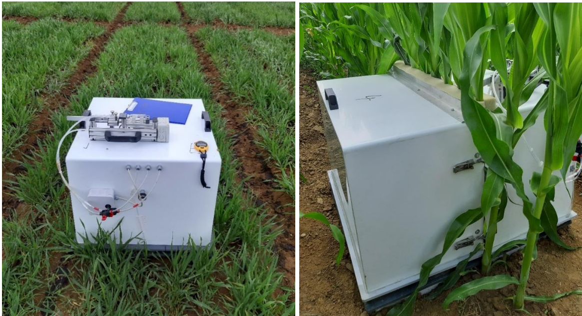
Abbildung 1: Messung der Lachgasemissionen mit der „Closed-Chamber-Methode“ im Weizenbestand (links), Messung im Maisbestand mit einer geteilten Haube (rechts).
