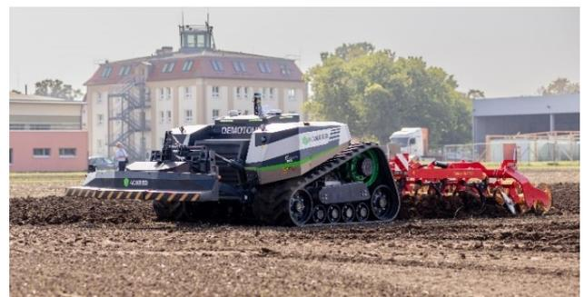
**Abbildung 2: Roboter zur Bodenbearbeitung**
